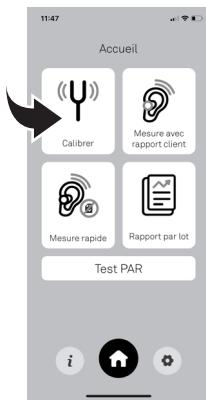
Afin d'effectuer des mesures précises, le système doit toujours être calibré en premier.
