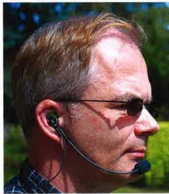
Das Phonak-Headset ist sehr leicht gebaut, die Ohrschalen werden nach Maß angefertigt. Das Freecom 7000 kostet (mit PJ-Stecker) ca. 1178 Euro.
